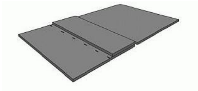
Bild 1: Überlappung mindestens 8 cm, bis 15 cm und Markieren z.B. mit Kreide
