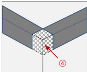
Sofern die Attika eine Ecke (4) aufweist, sind diese Flächen ebenfalls mit EPDM Dachbahn abzudecken. Die Stöße sind mit Formband abzudichten (vgl. Außenecke mit Formband).
