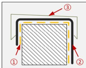
In der Regel wird der Mauerabsatz (Attika) vollständig mit EPDM Dachbahn (2) ganzflächig überklebt (1).
