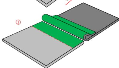
Beide Nahtflächen der EPDM Dachbahn (grün) mit Grundierung einstreichen und vollständig ablüften lassen. Mittels Fingerprobe überprüfen, ob vollständig abgelüftet ist.
