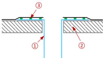
Anschließend mit der Andruckrolle gleichmäßig zwischen Flansch und Dachbahn verteilen/andrücken. Im inneren Randbereich des Gullyeinlaufes sollte Kleber heraustreten. So wird sichergestellt, dass rundum Kleber vorhanden ist.
