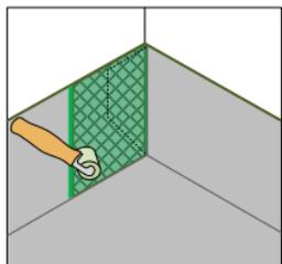
Erneut die Fläche grundieren und ablüften lassen. Anschließend die Fläche mit einem mindestens 15 cm breitem Abdeckband überkleben und mit der Andruckrolle fest andrücken.
