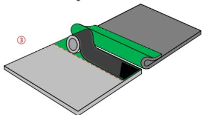
Nahtband auf den grundierten Bereich der unteren Dachbahn aufkleben. Auf der Oberseite verbleibt die transparente Schutzfolie des Nahtbandes.
