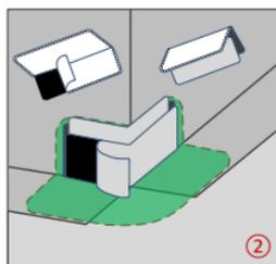
Formband (23 cm breit) mit der transparenten Schutzfolie nach außen falten. Eine Hälfte der Schutzfolie entfernen.
