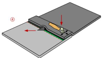
EPDM Dachbahn zurückschlagen (Schutzfolie des Nahtbandes bleibt darunter). Anschließend flach die Schutzfolie zwischen den Lagen der EPDM Dachbahn herausziehen. Danach mit der Andruckrolle kräftig andrücken.
